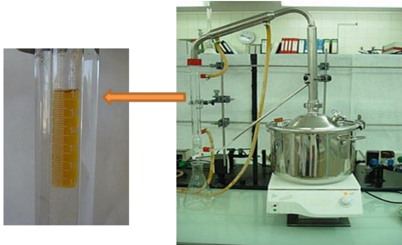
Figura 2. Destilador por arrastre de vapor (12 l) y detalle de bureta con aceite esencial e hidrolato
